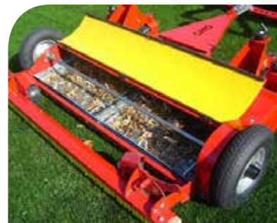
Selon nécessité, il est important de prévoir le ramassage des papiers, des feuilles, de toutes souillures affectant l'aire de jeu. Les machines à brosse rotative criblent le granulat et retirent toutes les impuretés de la partie supérieure du gazon synthétique.
