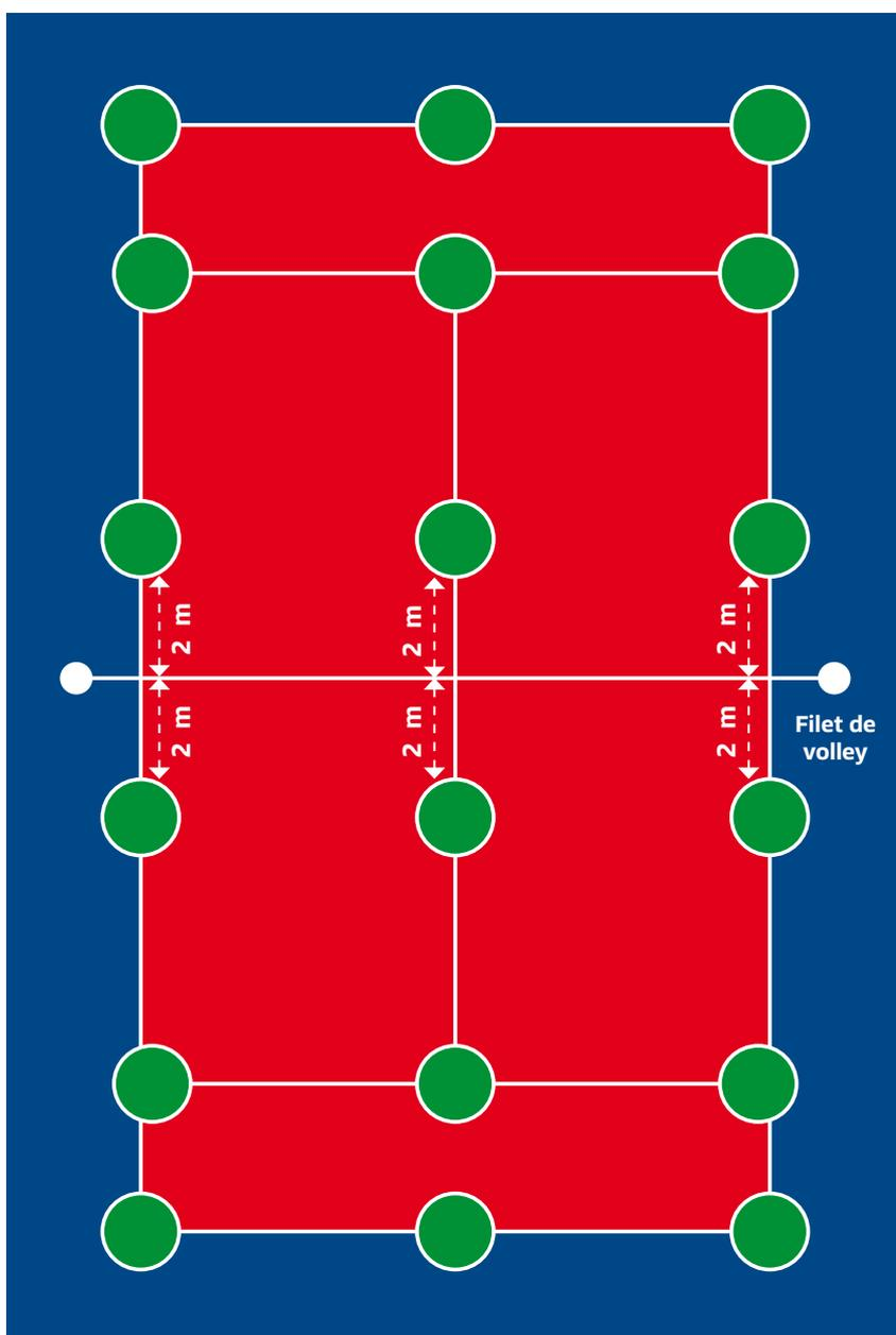
● Point à mesurer horizontalement au niveau du sol
